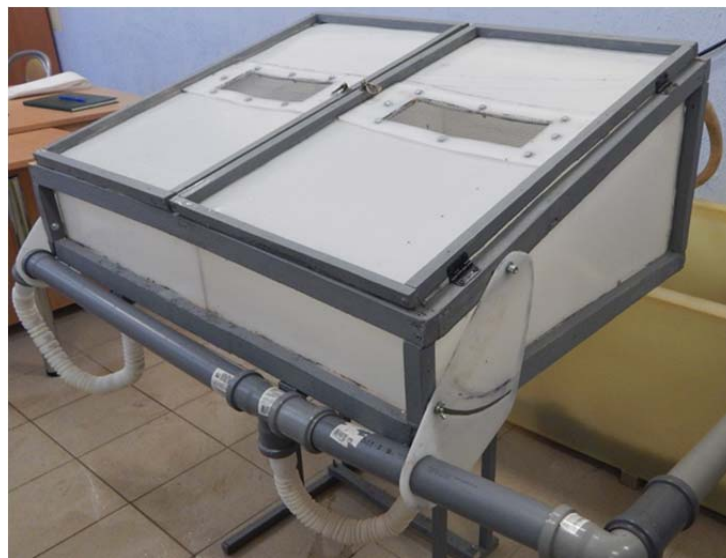
Рисунок 1. – Модульный аппарат для инкубации и выращивания молоди клариевого сома
