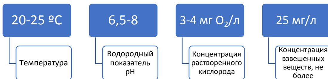
Рисунок 4. – Оптимальные условия для работы системы биологической очистки в УЗВ
