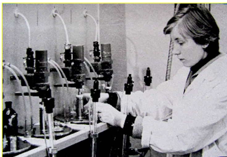
Оптимизацию состава питательных сред, изучение физиолого-биохимических особенностей стрептококка вели на сконструированной установке САУ-1 из 4-х ферментеров с регуляцией pH, температуры, скорости перемешивания
